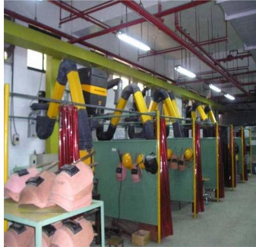
電焊機自清式排煙設備
